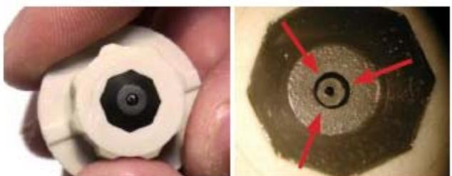
步骤 4. 重新组装喷嘴。将主要的螺丝小心地插回到喷嘴插口中。确保主要螺栓巢上的“翼”进入喷嘴插口中下部的插槽中。
