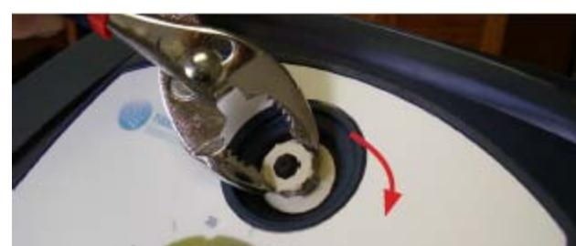
步骤 5. 小心地将喷嘴重新安装到 Halo 中，将喷嘴顺时针方向转动 90°来锁定到位。对喷嘴流的平直度进行 Halo 的测试。
