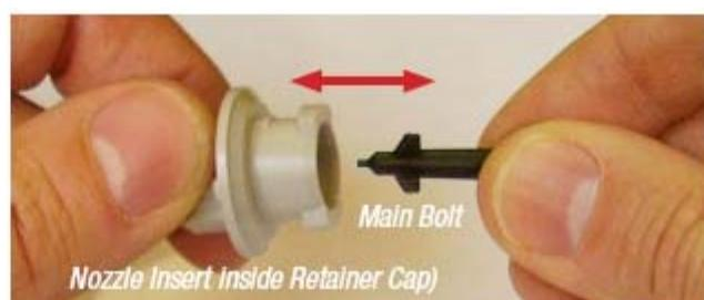
步骤 2. 移走喷嘴。使用可调手钳，小心地将喷嘴逆时针方向转动 90°并且移走。
