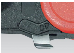
调整切割深度 Adjust cutting depth
