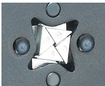
四边同步压接，均匀钳压，保证了精准的压线外型。方形压接确保了套管式端子具有最佳的接触面。按照端子的要求横截面积自动调节，方便操作。
